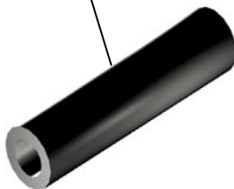
Combustibil cu bază dublă pentru motorul rachetă PKM – 4M
